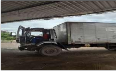
Foto 11: Caminhão baú muito próximo ao teto
